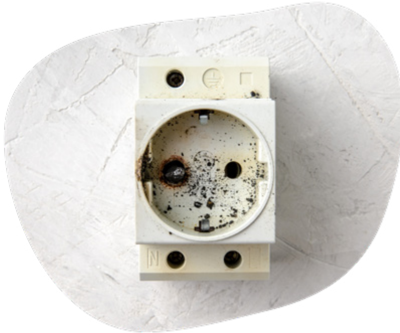
Lading på eksisterende stikkontakt kan føre til varmgang og brann.
